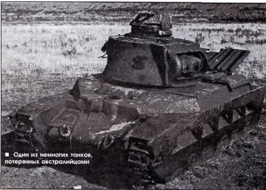
■ Пехотный танк Mk.II «Матильда». Танк вооружен 76-мм гаубицей в башне. Вокруг башни виден броневый барбет, также обращают на себя внимание откидные бронеколпаки над гусеницами
