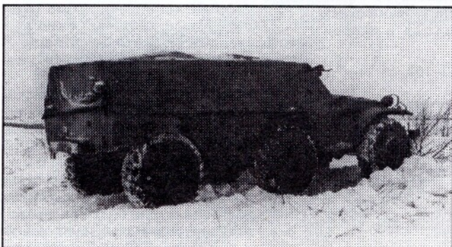
■ Бронетранспортер БТР-Э152В в момент преодоления ямы. Передний мост прошел, а задний подходит к препятствию. Испытания зимой 1957-1958 гг.
