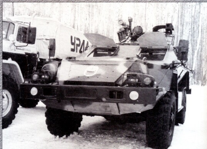
Новинка Камского автозавода - многоцелевой броневеомобиль БПМ-97, разработанный с широким применением агрегатов серийных грузовиков
