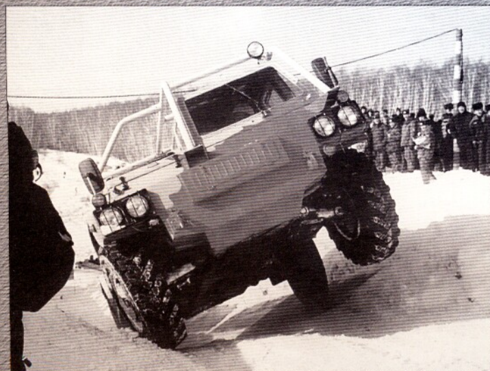
Последний рывок. На финише - "Драгун". Машина является "демилитаризованным" вариантом военного ГАЗ-3937
