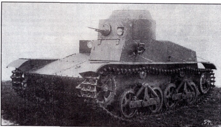
■ Опытный легкий танк Т-34 завода №185 с 7,62-мм пулеметом в башне. Рядом с пулеметом видна фара подсветки целей при стрельбе ночью
