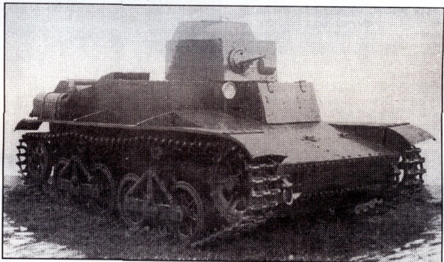
■ Опытный легкий танк Т-34 завода №185 с 7,62-мм пулеметом в башне. Рядом с пулеметом видна фара подсветки целей при стрельбе ночью
